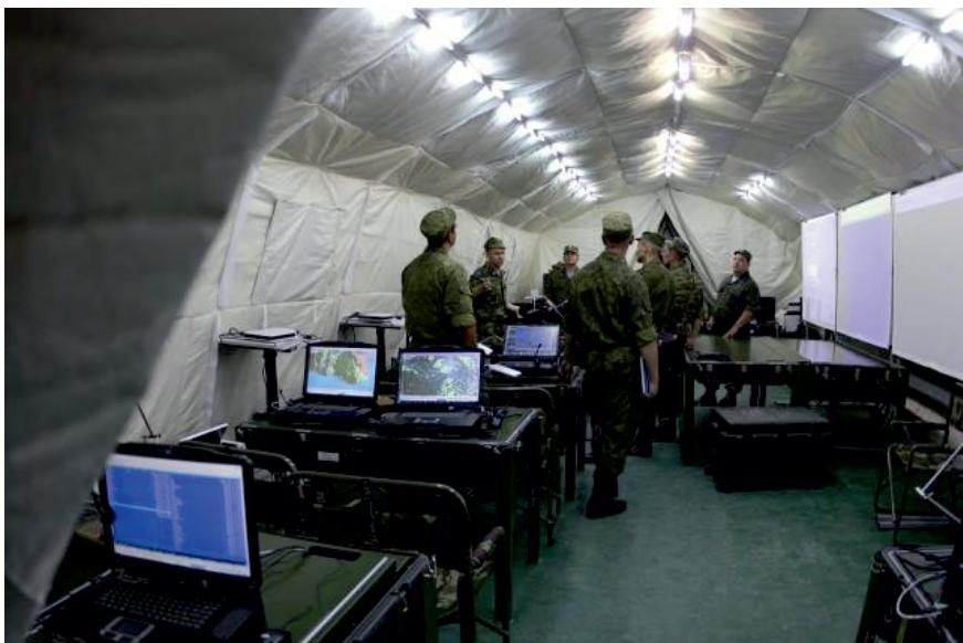
Модуль оборудован системами, обеспечивающими работу локальной сети с устройствами бесперебойного питания, громкоговорящей связью, четырьмя мультимедийными проекторами и экранами, 24-х дюймовым плottером, сканером, лазерным принтером. Каждый модуль имеет свои агрегаты для обеспечения автономного энергоснабжения.
