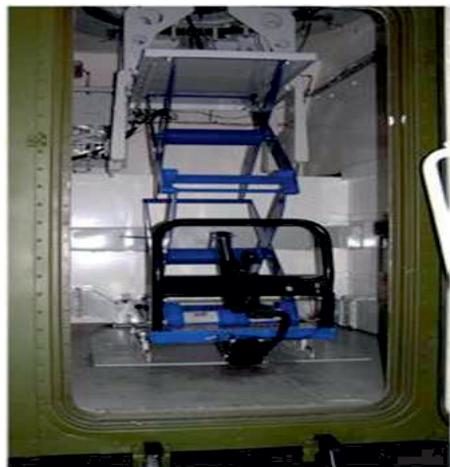
*Подъемное устройство антенны диапазона 7/8 ГГц в рабочем положении*
