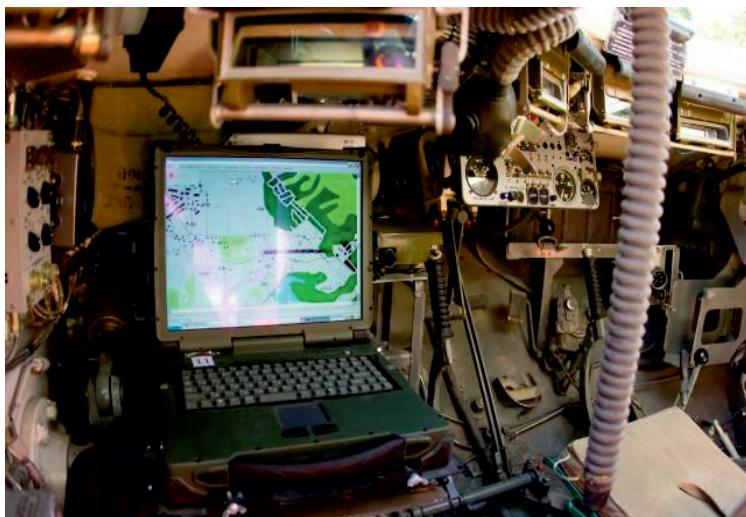
Каждая такая машина, до командира отделения включительно, оснащена аппаратурой ГЛОНАСС, и дублирующей инерциальной аппаратурой определения координат, позволяющей осуществлять позиционирование бронеобъекта, считывать направление и скорость передвижения на поле боя и передавать эти данные вышестоящему командиру по его «одноразовому» запросу, или периодически, то есть дискретно (в автоматическом режиме в указанные интервалы времени).
