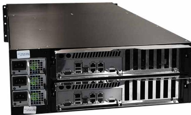
для организации надежного хранения и использования данных. Наличие двух контроллеров обеспечивает повышение общей надежности СХД — возможность избежать простоя при запланированном отключении или выходе из строя одного из контроллеров, а также дополнительное масштабирование производительности при распределении вычислительной нагрузки по разным контроллерам. Данная СХД создана в соответствии с российскими ГОСТами, регламентом Таможенного союза и имеет маркировку Евразийского соответствия.
