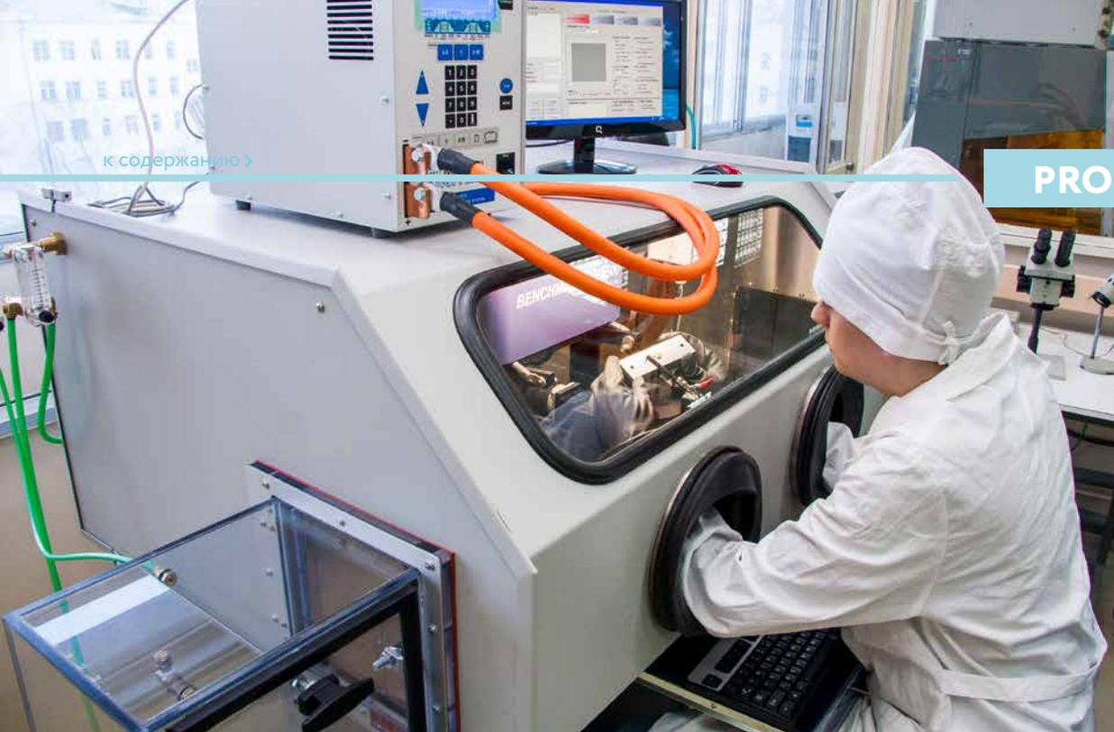
◀ Установка шовной роликовой сварки SM8500
